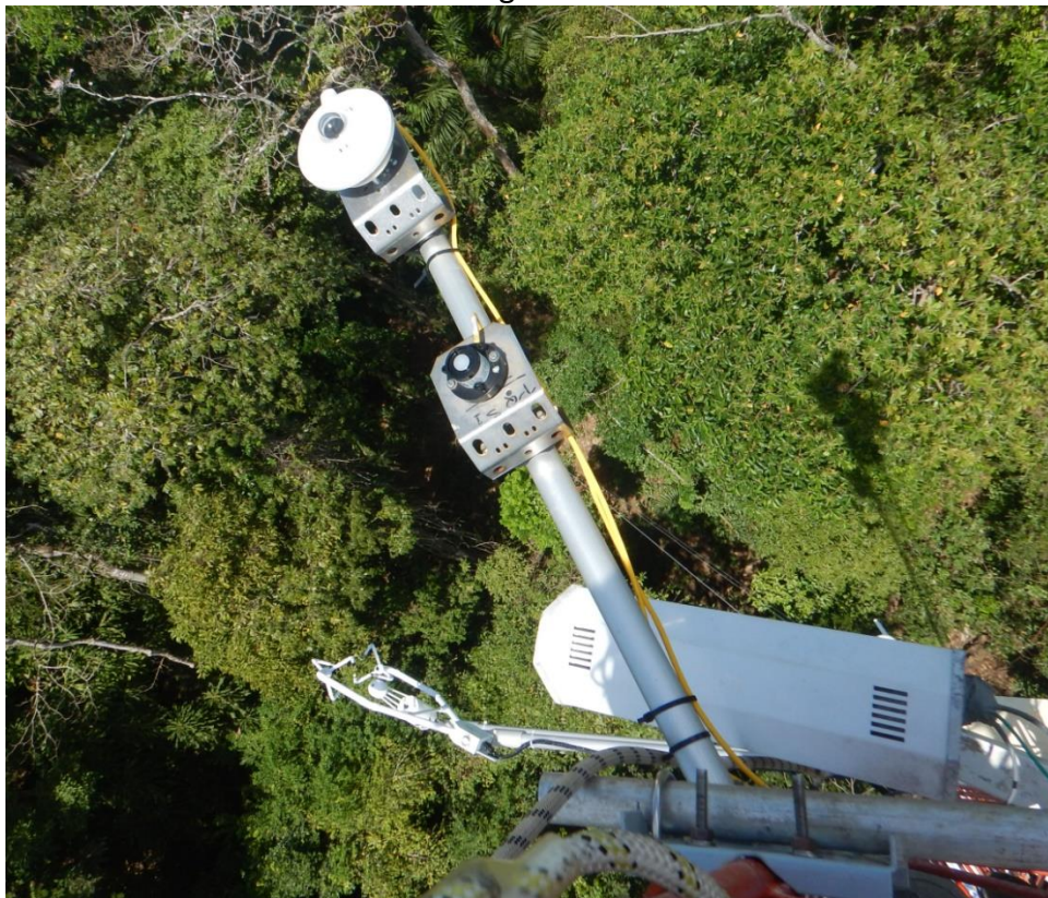
Kipp & Zonen CMP 3 pyranometer (end of pole) and PQS 1 PAR sensor
