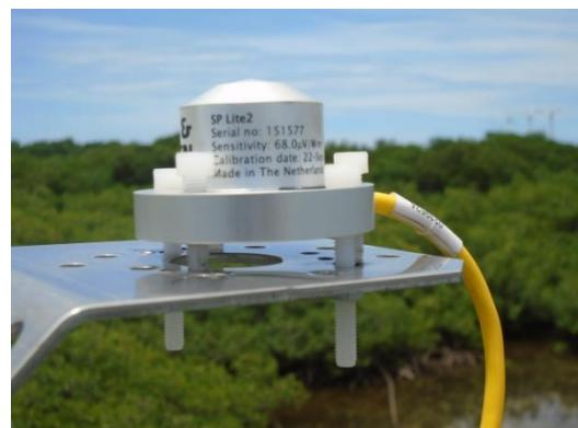
De 2004 a 2016, la radiación solar global fue medida en la torre del muelle con pirómetros Li-Cor LI200SB, conectados a dataloggers, registrando radiación total ( $MJm^{-2}$ ), máximos y mínimos ( $J m^{-2} s^{-1}$ ) a intervalos de 15 minutos. A partir de Sep. 13, 2016 los sensores de Li-Cor fueron reemplazados con pirómetros Kipp&Zonen SPLite2.
